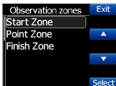
Chaque zone d'observation est définie avec deux angles, deux rayons et l'angle moyen (**Angle12**). Ces paramètres permettent de créer n'importe quelle géométrie pour le départ, les points et l'arrivée.
