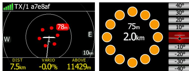
Une alerte Flarm peut être désactivée en appuyant sur n'importe quel bouton. Le temps de désactivation peut être configuré dans Setup.
