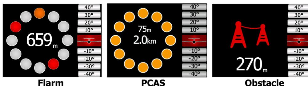
L'écran indique la position relative du danger. Sur la première image, deux planeurs approchent par la gauche à la même altitude et un autre approche par derrière, sur la droite. La seconde image est un exemple d'une alerte non directionnelle (mode AC). Le nombre du milieu indique la distance horizontale à la cible. La dernière image montre une alerte d'obstacle.
