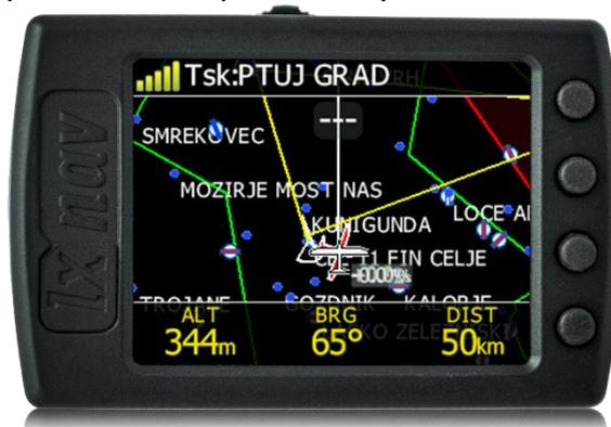
La fonction de chaque bouton poussoir est décrite dans le label bleu adjacent au bouton. Un label peut avoir deux options avec la seconde option labélisée en rouge. C'est le cas quand le bouton possède deux fonctions. L'option bleue est active avec un appui court et l'option rouge un appui long. Typiquement la seconde option est souvent l'inverse de la première, ex : Next/Previous (suivant/précédent), Insert/Delete (insérer/supprimer), Ok/Cancel (Ok/annuler), forward/backward (avancer/reculer).
