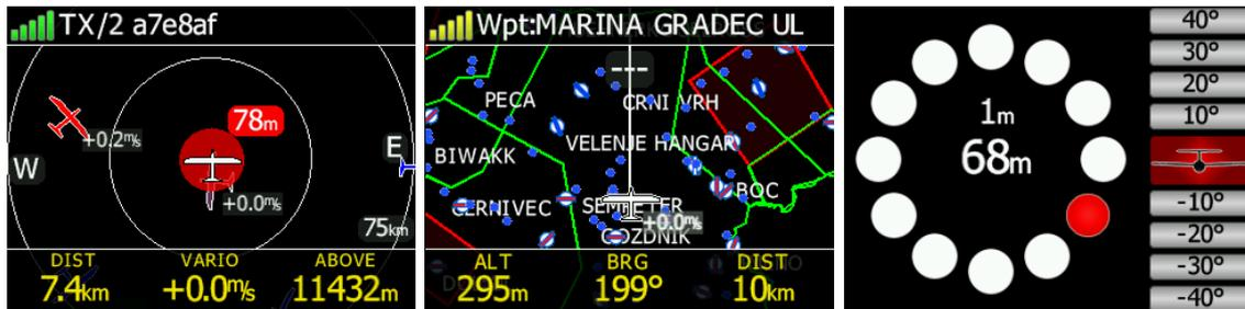
Les alertes PCAS sont représentées avec un cercle formé par des points avec l'altitude relative, l'alerte PCAS est affichée avec des lumières rouges ou oranges sur l'anneau horaire. (Les informations de cibles PCAS affichent uniquement une distance, mais pas de direction).
