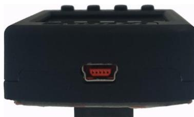
Sur le côté gauche se trouve un connecteur mini USB, utile pour transférer les données.
