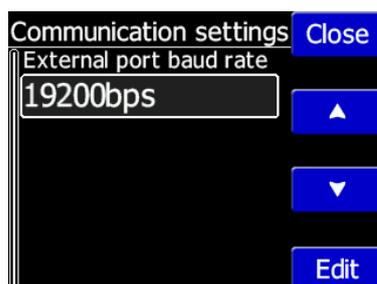
Dans le menu "communication", vous pourrez paramétrer le baudrate du port externe. Les appareils Flarm fonctionnent généralement en 19200 bps.
